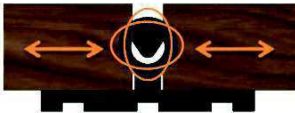
Abbildung: Aufnahme der Quell- und Schwindvorgänge
