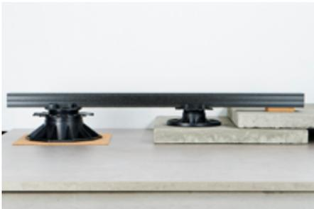
1. Nach Ausrichten der Unterkonstruktion, wofür verschieden Materialien zur Verfügung stehen (Drehfüße, Gummi- bzw. Korkpad je nach Untergrund), starten wir mit der Verlegung der Dielen.
