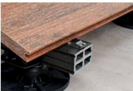
2. **Anfangs-/Endklammer mit der beigelegten Schraube an der jeweiligen Unterkonstruktion befestigen.** Erste Terrassendiele einschieben. Auf Breite geschnittene Dielen können auch mit der Spezialschraube sichtbar befestigt werden, hierbei immer vorbohren und ansenken. Ohne vorbohren und versenken kann das Material aufspalten und sich aufstellen.
